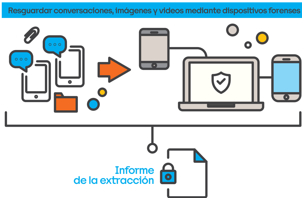
Figura 2. Extracción de información mediante UFED
